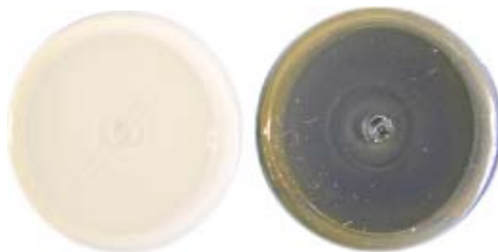
劣化したボトル (ボトル底部が白色化)
