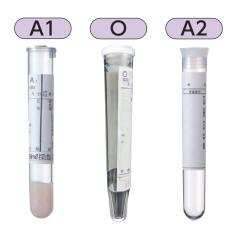
③血清1.0mLを正確に〇容器に移し替え、 転倒混和します。(血清が白濁します。)
